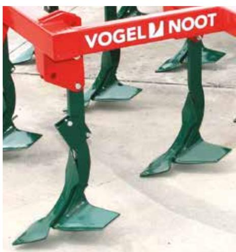
Данная комбинация подходит как для обработки тяжелой почвы на средней глубине, так и неглубокой мульчирующей, предпосевной подготовки. Регулируемый угол профиля у односторонней стрелчатой лапы гарантирует лучшее втягивание также на твердых почвах. Направляющие щитки на лапах первого ряда улучшают поток земли.
