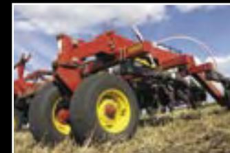
Рычажные механизмы параллелограммного рычага посажены на не требующие смазки долговечные втулки из композиционных материалов. Литые компоненты и надёжные
