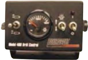
Посевная система 3710 оснащена уникальным компонентом - блок гидравлического управления, позволяющий из кабины трактора контролировать
