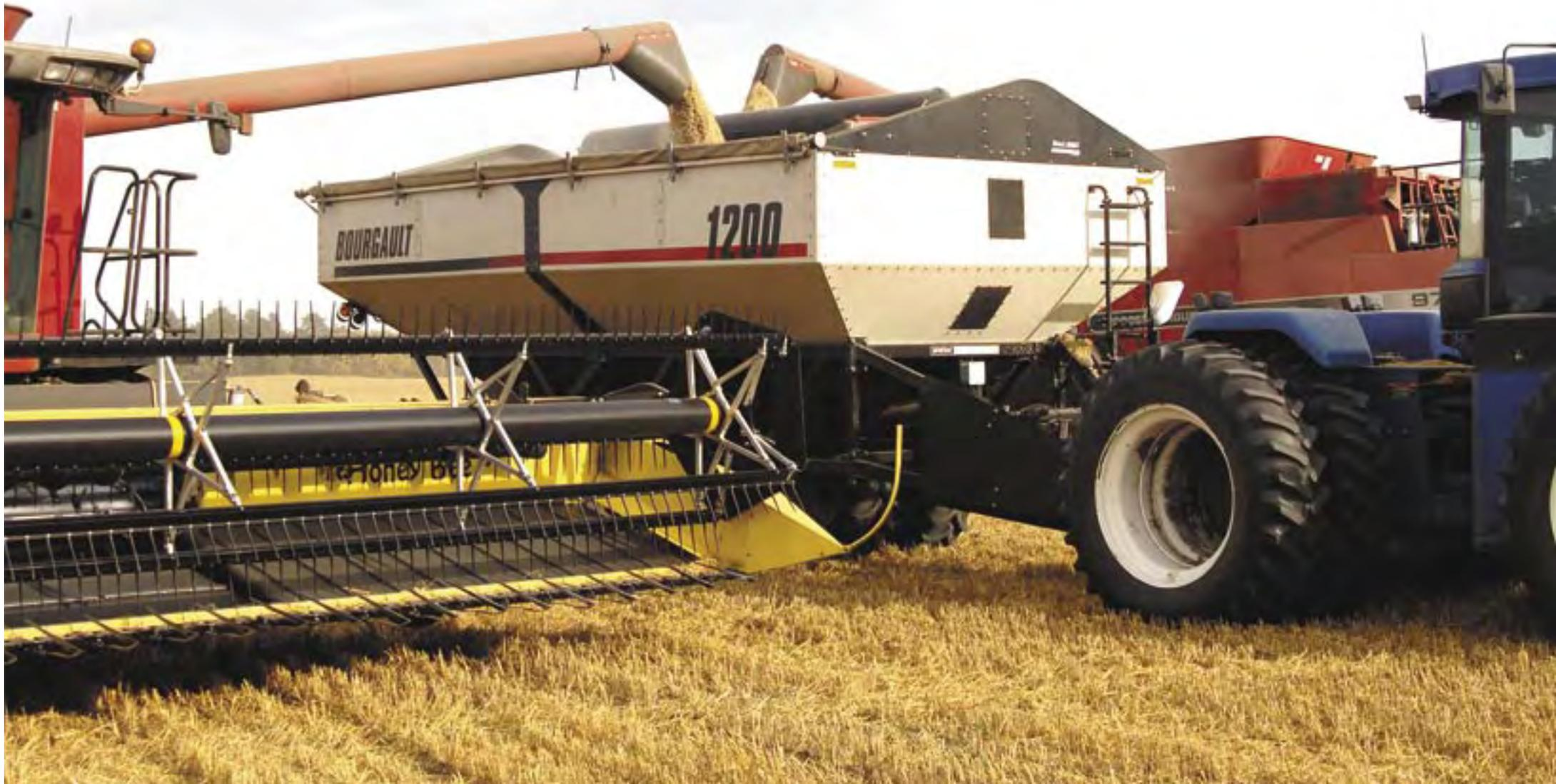
Благодаря широкой ходовой части и балансирующим двойным осям (*вперед-назад и из стороны в сторону*) устойчивость бункера гарантируется в любых полевых условиях и на рельефных участках, позволяя развивать большую рабочую скорость и снижать необходимое тяговое усилие. Ходовая часть бункера отличается высокой надежностью, основные узлы ходовой части имеют соединения не требующие смазки.
