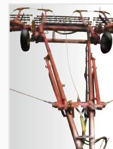
Тросы, связывающие крылья с передней частью прицепного устройства снимают рабочую тяговую нагрузку, а пара дополнительных тросов, расположенных с задней части балки ограничивают движение крыльев вперед, придавая дополнительную стабильность в работе широкозахватному агрегату.
