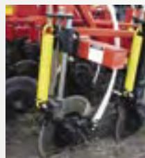
Сеялка 5725 разработана с учётом применения системы MRB (внесение удобрений в междурядья культур). Диски MRB работают независимо от дисковых сошников сеялки, и могут вносить  $NH_3$ , гранулированное или жидкое удобрения. Удобрения вносятся на безопасном расстоянии от семян, предупреждающем выжигание семян удобрением. Посев выполняется за один проход с сохранением качественного посевного ложа, влаги и оптимальных условий для прорастания культур.
