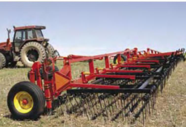
Каждая секция бороны оснащена пружиной, работающей на растяжения.
