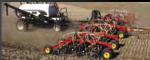
Каждый сошник данного агрегата независимо копирует рельеф поверхности поля и гарантирует точность и равномерность глубины заделки семян при различных почвенно-погодных условиях. Имеется возможность оснащать сошники данной модели разными типами анкерных насадок в зависимости от требований высеваемой культуры и агрономической службы хозяйства.
