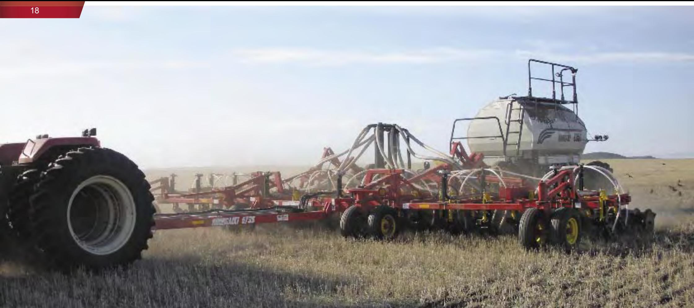
Минимальное нарушение почвенного слоя дисковыми рабочими органами во время посева дает максимальные преимущества в засушливых условиях. С агрегатом модели 5725 Вы без проблем можете проводить посев по высокой стерне и гарантированно разделять семена и удобрения при посеве за один проход, используя систему MRB.
