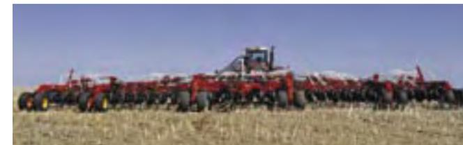
Посевной комплекс Bourgault 3710 по заказу может иметь междурядье 19, 25 и 30 см с шириной захвата 12,2, 15,3 и 18,2 метров. При необходимости использования более широкого междурядья для посева технических культур (соя, подсолнечник, силосная кукуруза) имеется возможность гидравлическим клапаном заблокировать один ряд сошников на моделях с междурядьем 19 и 25 см, и получить, таким образом, междурядье 38 или 50 см.
