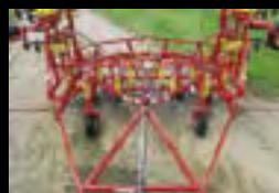
Прицепное устройство модели 9400 имеет три точки соединения с рамой, что способствует равномерному распределению тягового усилия мощного трактора при работе на самых разнообразных почвах и большой глубине обработки. Длинное прицепное устройство (6.1 м на пятисекционных моделях) способствует стабильности агрегата в суровых условиях работы.
