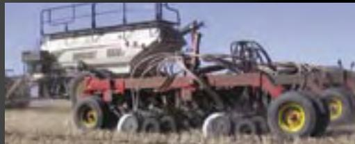
В модели 3710 с дисковыми сошниками компания Bourgault продемонстрировала совершенно новый подход к дизайну систем с независимым контролем рабочей глубины каждым сошником. Данная машина - это парадигма в новых технологиях дизайна и создания сошников. Посевной комплекс 3710 предоставляет возможность выбора рабочей ширины захвата от 12,2 до 18,2 м и гарантирует высокую надежность конструкции.
