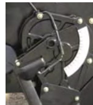
Усиленная конструкция бесступенчатой трансмиссии с плавным изменением передач гарантирует сохранение точной нормы высева даже в самых тяжелых условиях. Привод измерительной системы осуществляется от ходовой части бункера.
