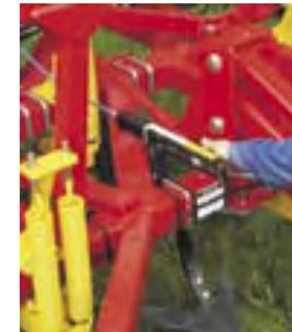
Установка требуемой рабочей глубины на агрегатах Bourgault 8810 выполняется за секунды по всей ширине рамы посредством гидравлической системы машины. Точность рабочей глубины и ее соблюдение обеспечивается с помощью запорного клапана, который предотвращает ток
