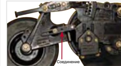
Фиксация балансира устраняет тандемное копирующее действие прикатывающего и чистящего колес
