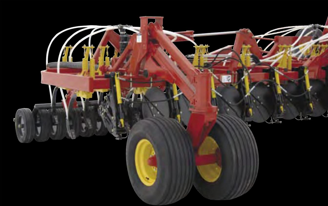
**НЕПРЕВЗОЙДЕННАЯ ФЛОТАЦИЯ** Большие самоориентирующиеся колеса с конструкцией «ходовой» оси снижают давление веса комплекса на кв.см поверхности почвы, снижая тем самым ее уплотнение, упрощают транспортировку и гарантируют непревзойденную флотацию на поле во влажных условиях.
