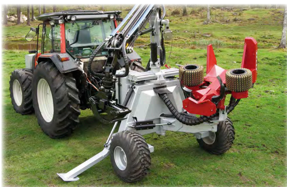
Hypro 755 ist mit hydraulischen Stützen ausgerüstet.
