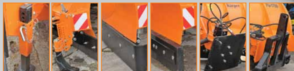
опора скользюны металлический нож из стали HARDOX резиновый нож система подвески EURO SMS TCH
