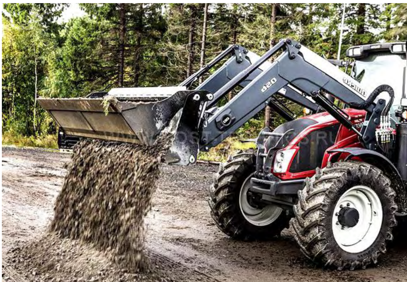
Вторая операция: Разгрузка через днище, с улучшенной высотой опорожнения
