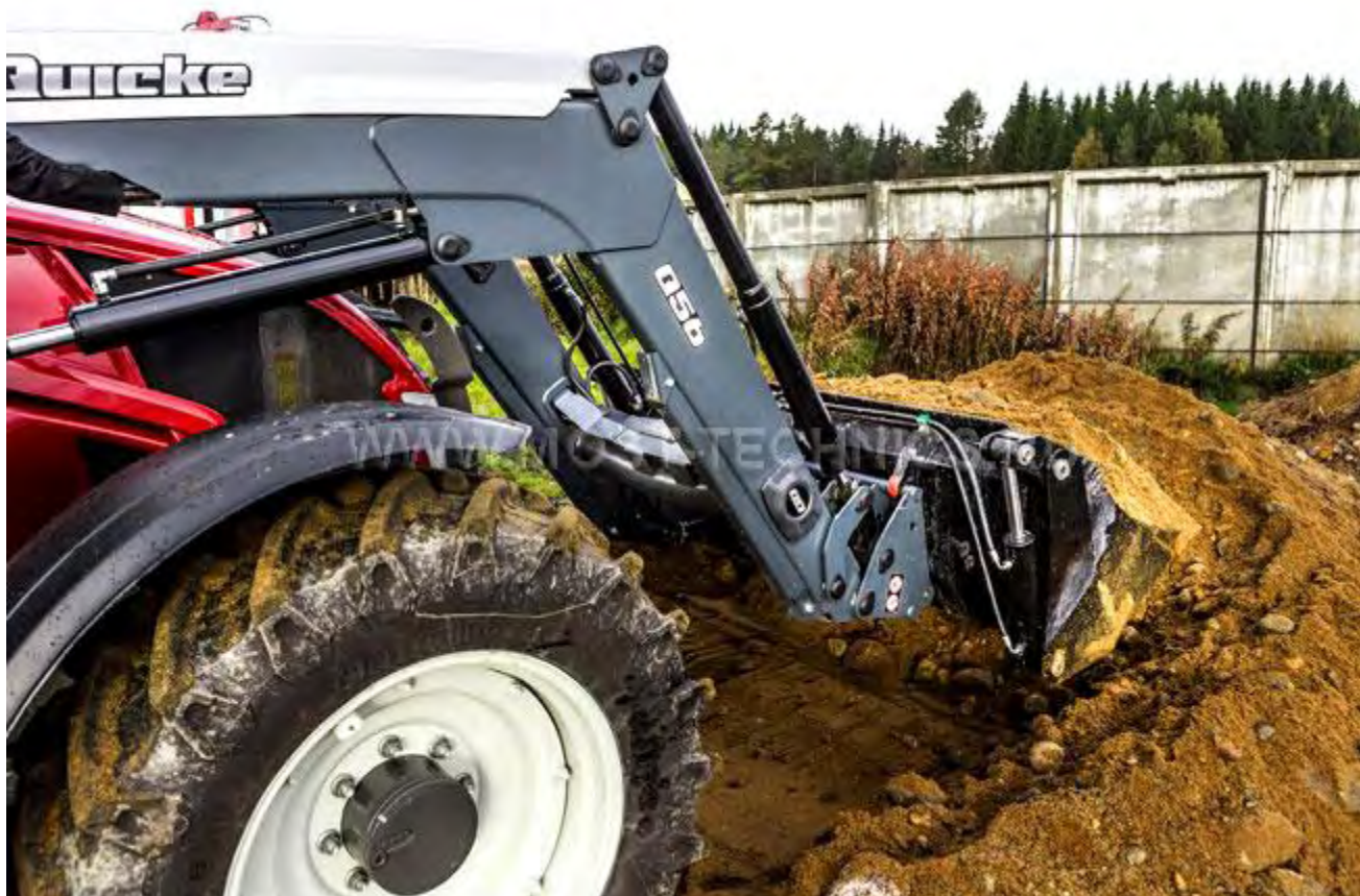
Вторая операция: Разгрузка через днище, с улучшенной высотой опорожнения
